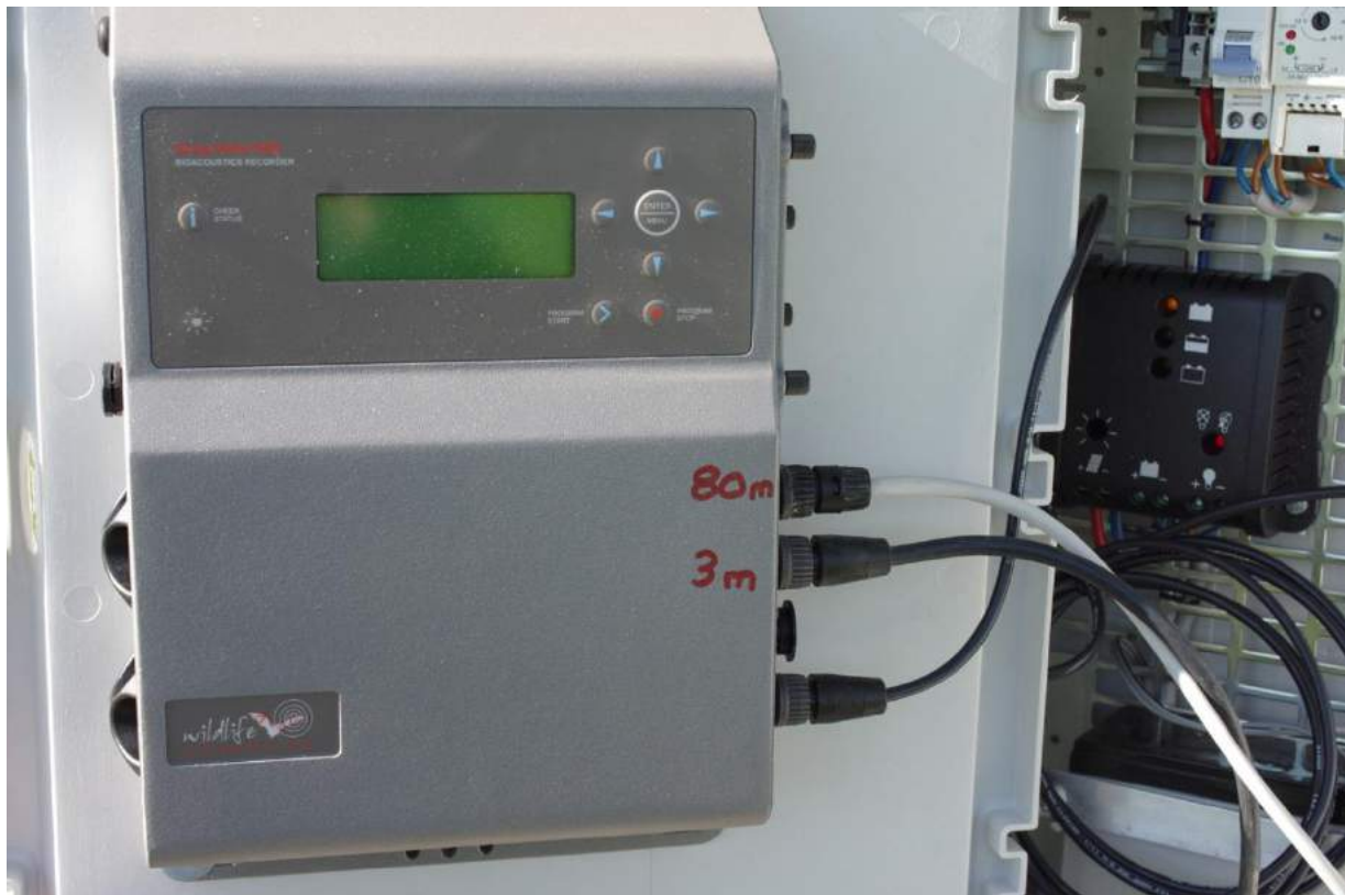
Figure 9 : SM3bat installé sur le mât de mesure avec ses deux sorties micros
